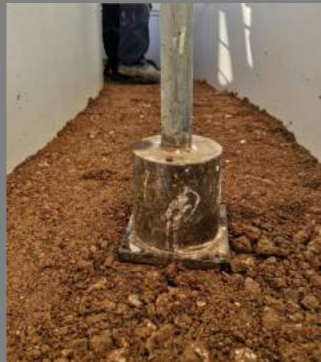
SUCCESSIVE COMPATTAZIONI MECCANICHE (strato compattato 7cm)
